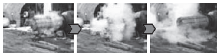
IQRフレームレス爆発放散口による放散 直後の表面温度は100℃以下 水蒸気、煙、最小限の圧力波が放散
