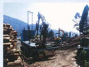
【木材運搬車】 木材をつかんで、積込・運搬する機械
