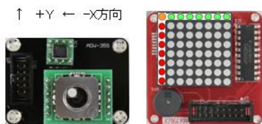
ジョイスティック+Y- \times 方向移動 LEDは左1列を赤色、上1列を緑色、 左上角1個をオレンジ色で点灯する
