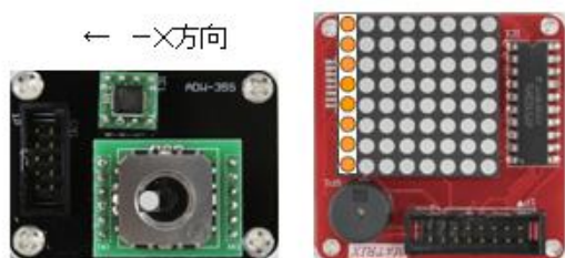
ジョイスティック-X方向移動 LEDは左1列オレンジ色で点灯する。
