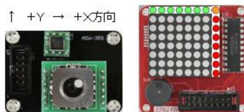
ジョイスティック+Y+ \times 方向移動 LEDは右1列を赤色、上1列を緑色、 右上角1個をオレンジ色点灯する。
