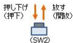
列が最右列に来て、さらにSW2を押下、解放すると、点灯ラインは最左列へ移動
